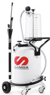
Aspirador de aceite usado de succión con pre-cámara de vacío y depósito total de 70 litros. Unidades con cámara transparente de 10 litros que se puede utilizar como depósito de vacío y permite una visualización inmediata del aceite usado extraído. Se puede usar de forma remota después de haber creado el vacío dentro del depósito de acero. Se descarga a través de una manguera de descarga de 1,5 m que presuriza la unidad. Incluye válvula de seguridad para evitar sobre presurización.
